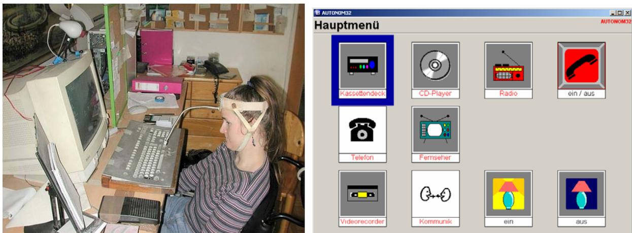
Abb.4: Die Biologiestudentin M. Hela hinter ihrem PC, den sie mit Kopfstab bedient. Hat sie den Kopfstab nicht auf, kann sie das Autonom-System im Scanning-Modus mit dem Einfachstaster (links neben der Tastatur) ansteuern. Rechtes Bild: Hauptmenü des Autonom-Systems von M.Hela.
