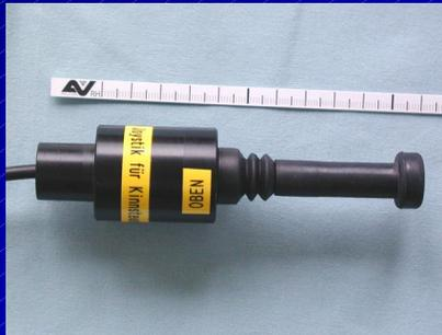
Saug-/Blas-Schalter mit stufenlos einstellbarem Saug- Blaswiderstand (0,5 - 34,0 kPa)
