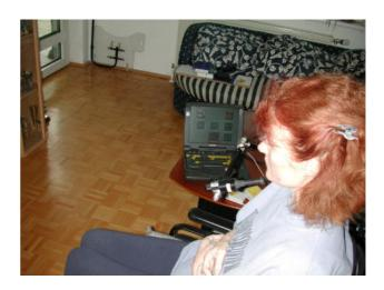
Bild 6: AUTONOM im Feldtest zur Umgebungssteuerung. Links das AUTONOM Konfigurationsprogramm mit dem die Eigenschaften des Systems von der Betreuungsperson eingestellt werden (hier das Menü zur Steuerung des TV Gerätes). Rechts die Anwenderin, die das System über einen Kinnjoystick steuert.
