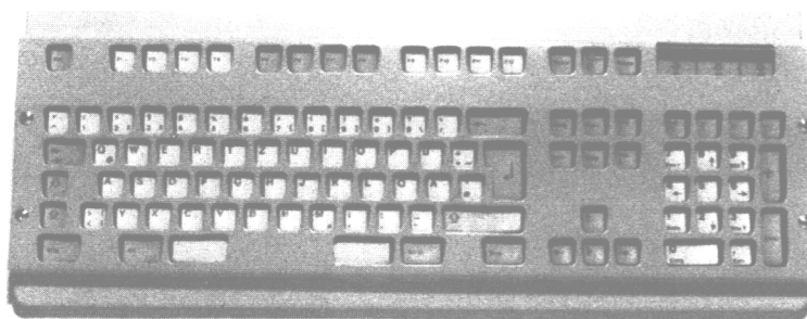
Abbildung 1.4: Standardtastatur mit Abdeckung zur Verhinderung von Fehleingaben [8]
