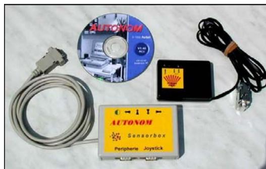
Abb.2: Einige Komponenten der kommerziellen Version von Autonom, wie es von zwei österreichischen Firmen [Meschik], [Mechatron] angeboten wird. CD-ROM mit Autonom Software, Infrarot-Sender zur Umgebungssteuerung, Autonom Sensorbox zum Anschließen der Eingabetaster.
